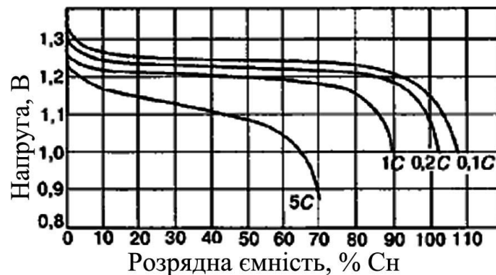
Рисунок 1.6 – Розрядні характеристики нікель-кадмієвого акумулятора (Ni-Cd) при різних струмах розрядження
