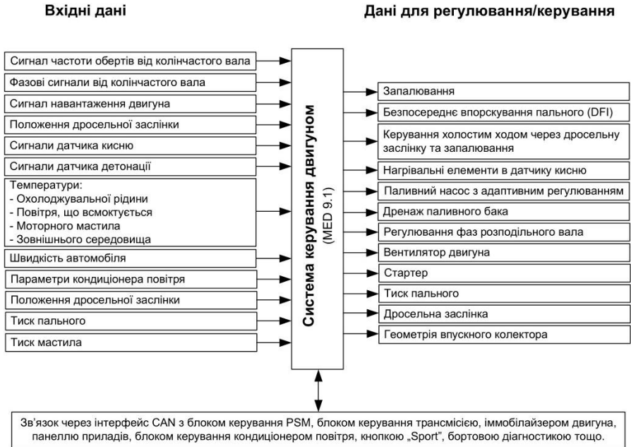
Рисунок 9.8 - Схема інформаційних потоків системи керування двигуном MED 9.1
