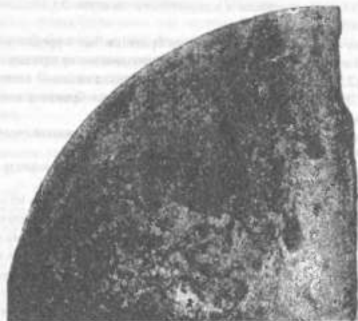
Рисунок 7.20 – Макроструктура спеченной заготовки из разреза торцевой части капсулы
