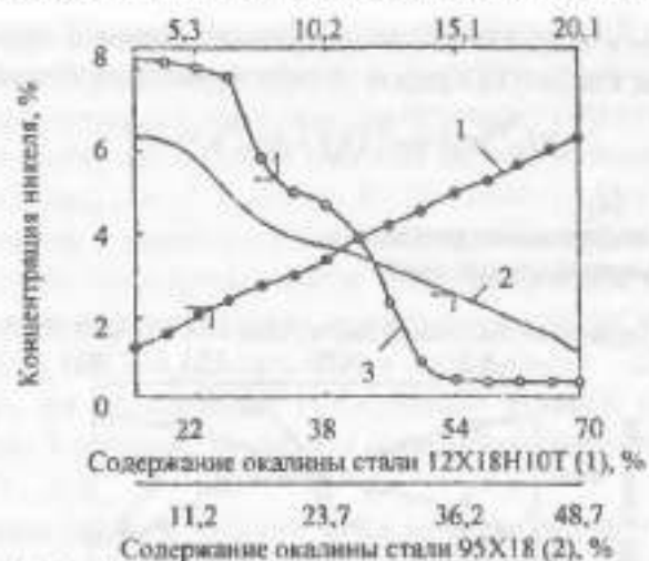
Рисунок 7.34 – Зависимости концентраций никеля в порошке от содержания компонентов в шихте, % мас [242]
