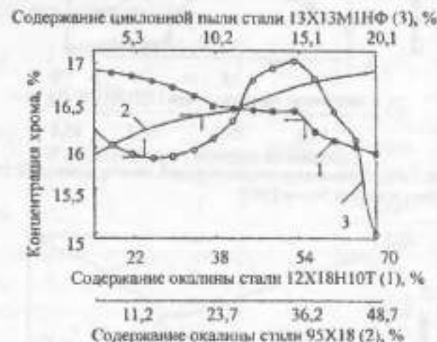
Рисунок 7.33 – Зависимости концентраций хрома в порошке от содержания компонентов в шихте, % мас [242]
