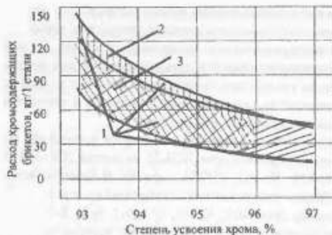
Рисунок 7.36 – Усвоение хрома расплавом стали из хромосодержащих брикетов по ТУУ 322-297-04-96, % масс. при выплавке в печи
