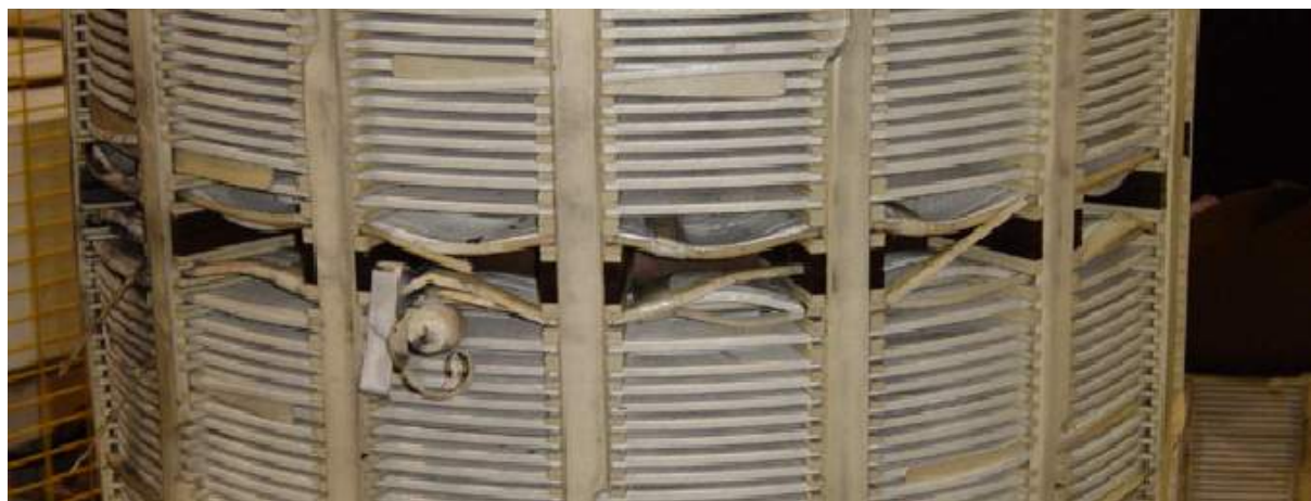
Рисунок 1.9 — Осьовий вигин провідників.
