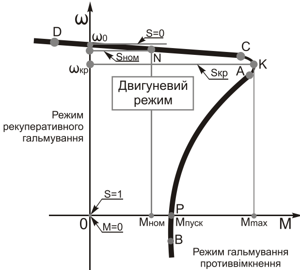
Рисунок 3.36 – До аналізу механічної характеристики АД в координатах \omega = f(M) .
