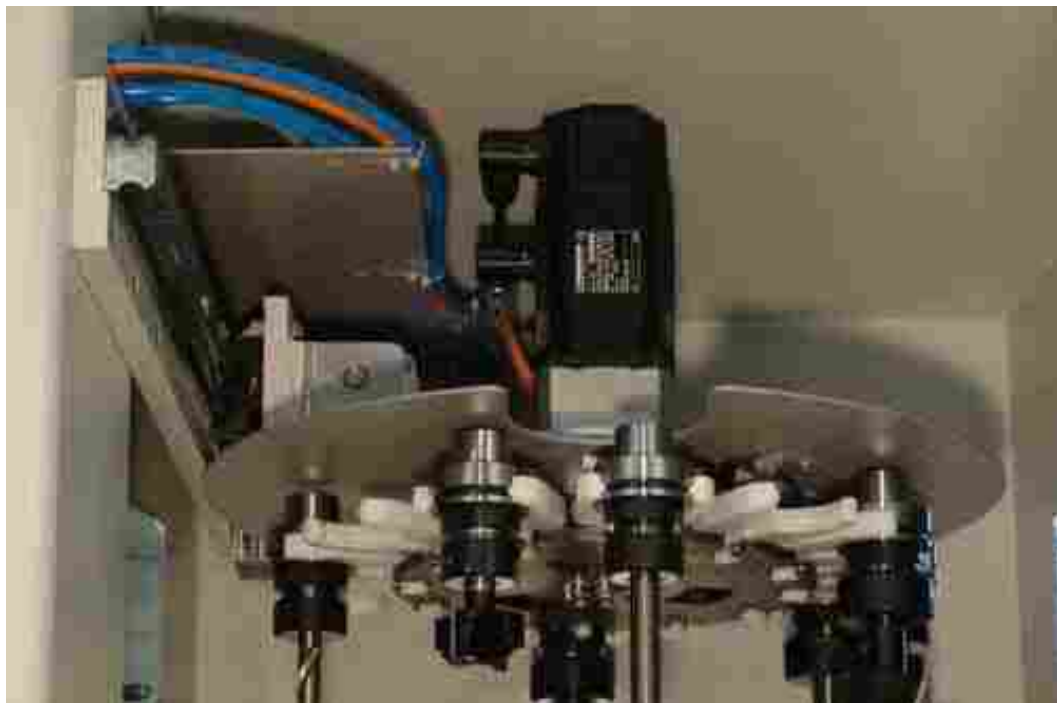
Рисунок 3.2 – Ріжучі інструменти в магазині верстата з ЧПУ
