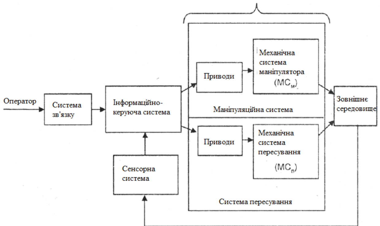
Рисунок 1.1 – Функціональна схема робота у загальному вигляді
