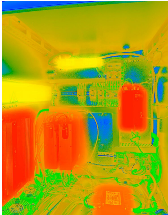
Рисунок 2.37 - Теплова карта в середині електронно-комутаційної шафи верстата Biesse Rover a 1632
