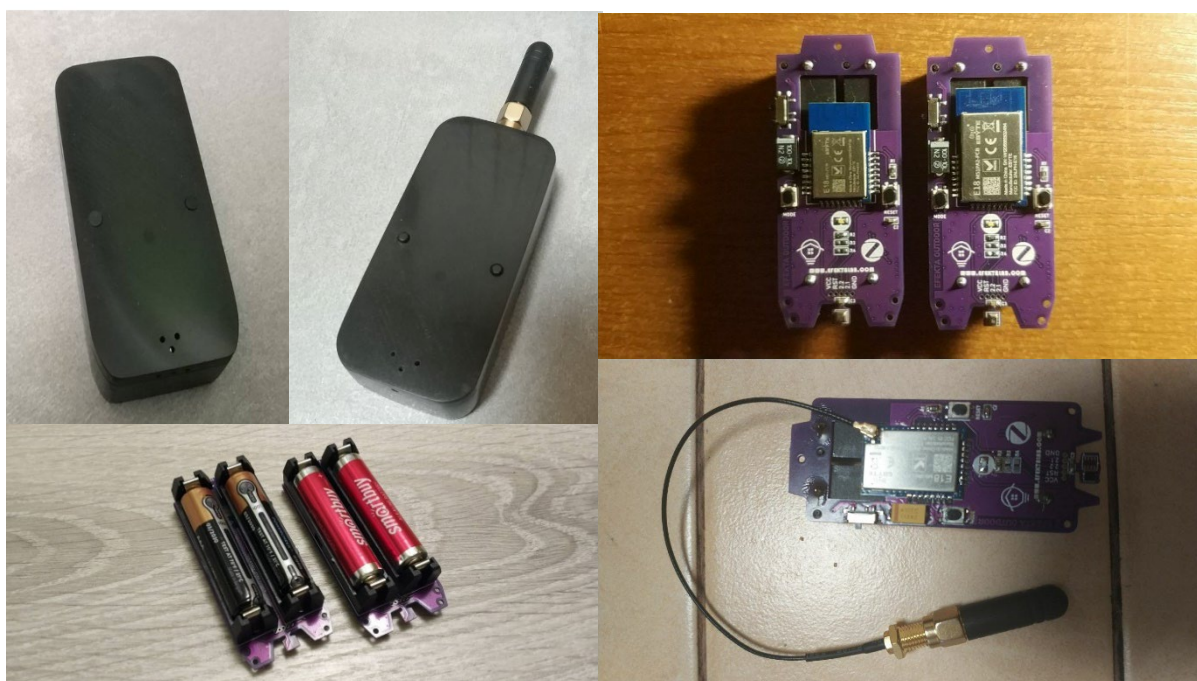
Рисунок 2.12 – Фото датчика, друкована плата та датчик в корпусі з зовнішньою антеною
