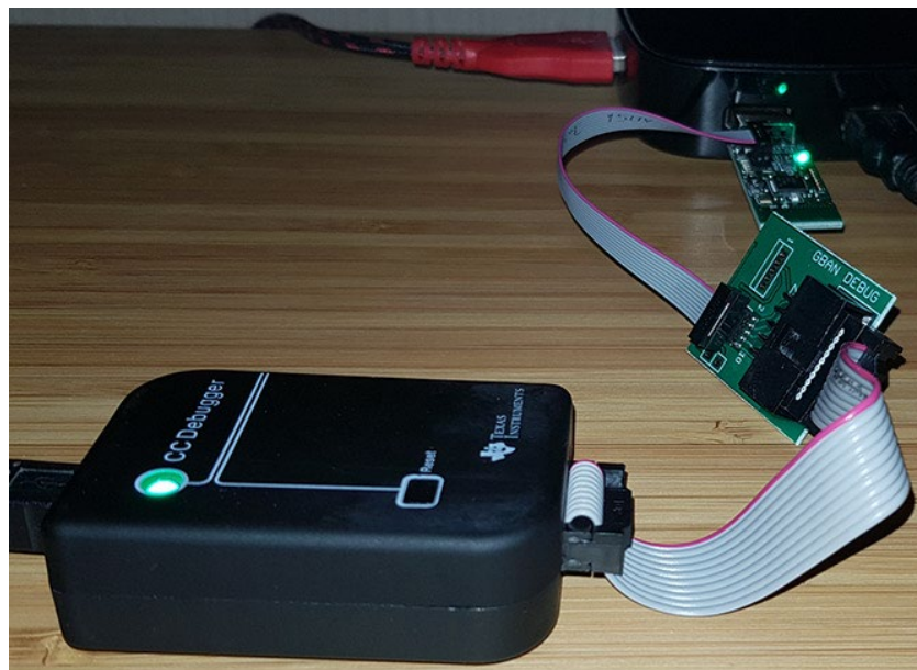
Рисунок 2.18 – Підключення USB ZigBee Sniffer до програматора
