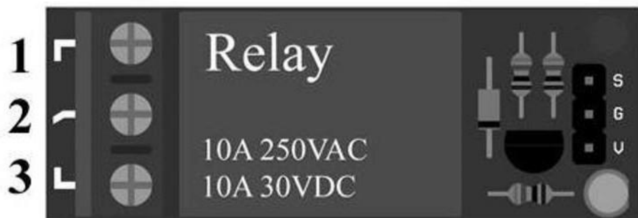
Рисунок 2.10 – Схематичне зображення реле (вид зверху)
