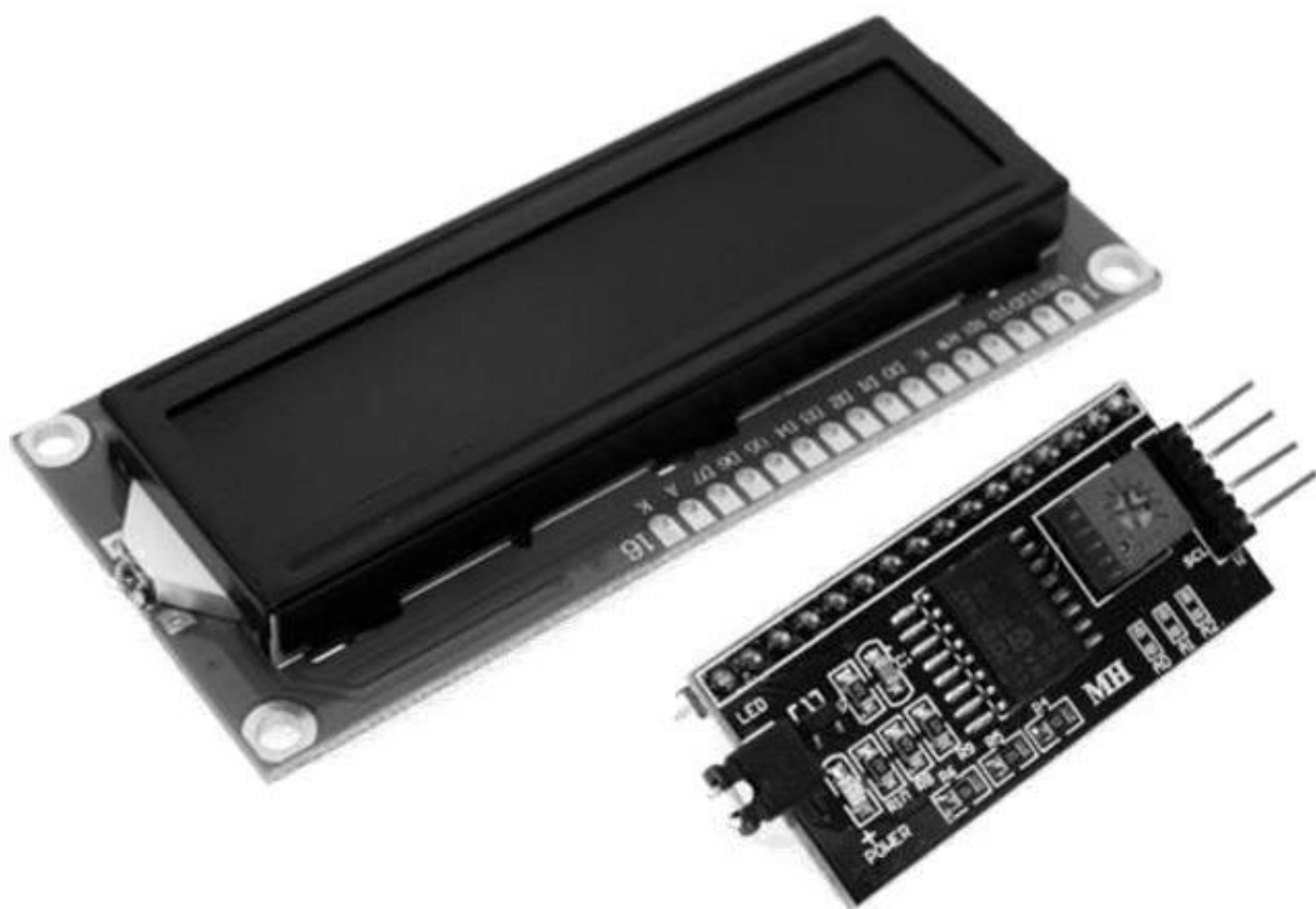
Рисунок 2.8 – Дисплей LCD1602 та плата підключення I2C-інтерфейсу
