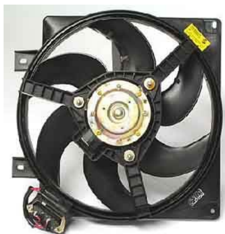
Рисунок 3.19 – Зовнішній вигляд вентилятора в системі охолодження
