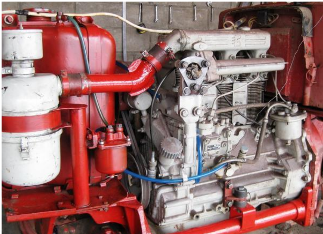
Рисунок 2.1 – Дизельний двигун Д130, встановлений на трактор [17]
