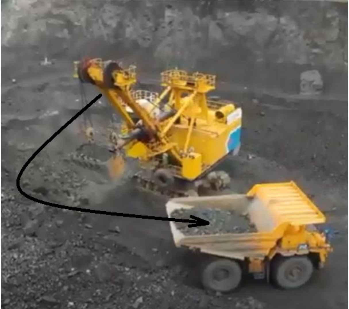
Рисунок 1.2 – Робота екскаватору у вузькому забої Північно-Західного кар'єру
