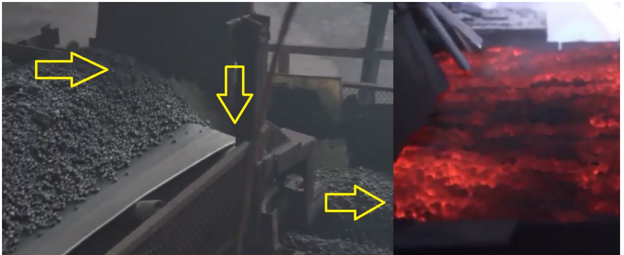
Рисунок 1.8 – Переміщення котунів стрічковими конвеєрами
