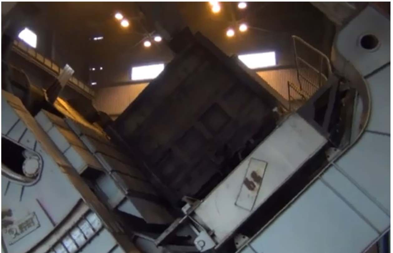
Рисунок 1.3 – Робота вагоноперекидача складу вугілля
