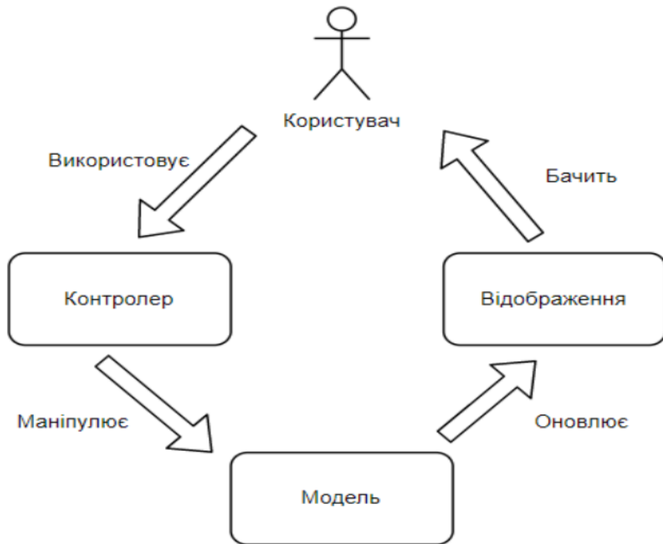
Рисунок 3.2 – Структура серверної частини програмного забезпечення для стиснення зображень на основі патерна MVC
