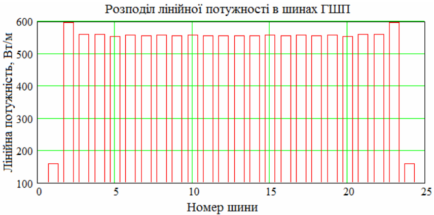
Рисунок 2.2 – Розподіл лінійної потужності тепловиділення в шинах ГШП в режимі максимального навантаження
