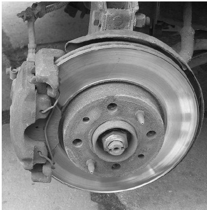
Рисунок 2.3 – Дисковий гальмівний механізм
