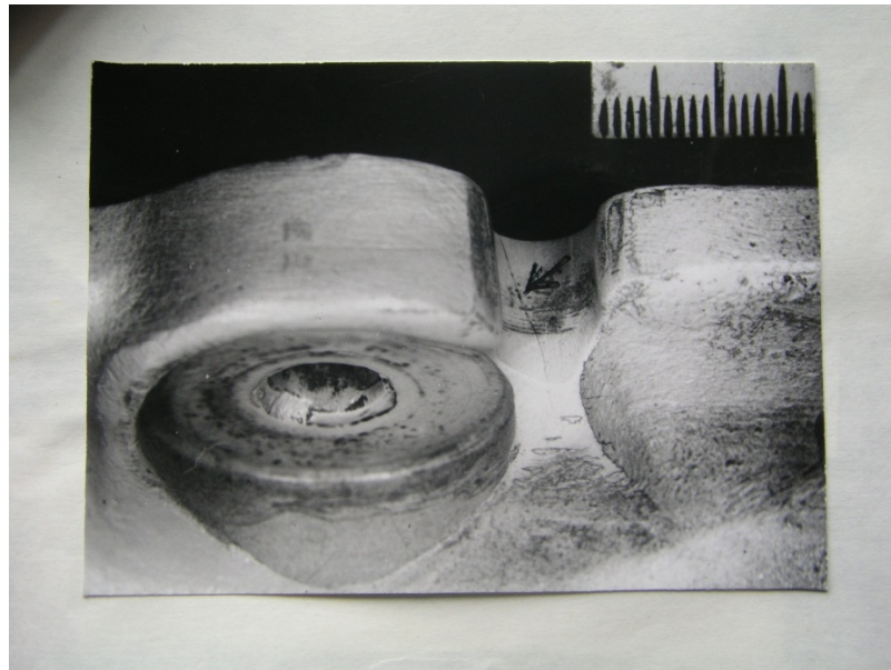
Рисунок 3.1 – Авіаційна виливка зі сплаву МЛ5: корпус коробки приводу
