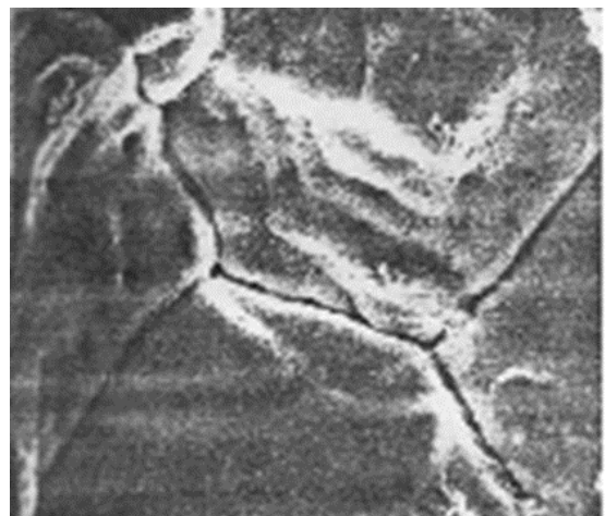
Рисунок 3.2 – Характерний макрозлам (а, х3) і мікроструктура сплава МЛ5 (б, х300)
