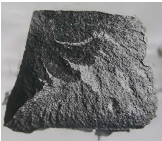
Рисунок 3.2 – Характерний макрозлам (а, х3) і мікроструктура сплава МЛ5 (б, х300)
