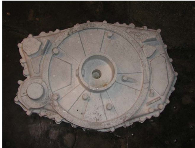
Рисунок 3.11 - Виливок «корпус коробки приводу», виготовлений з поліпшеного магнієвого сплаву МЛ5, модифікованого вуглецем х 0,6
