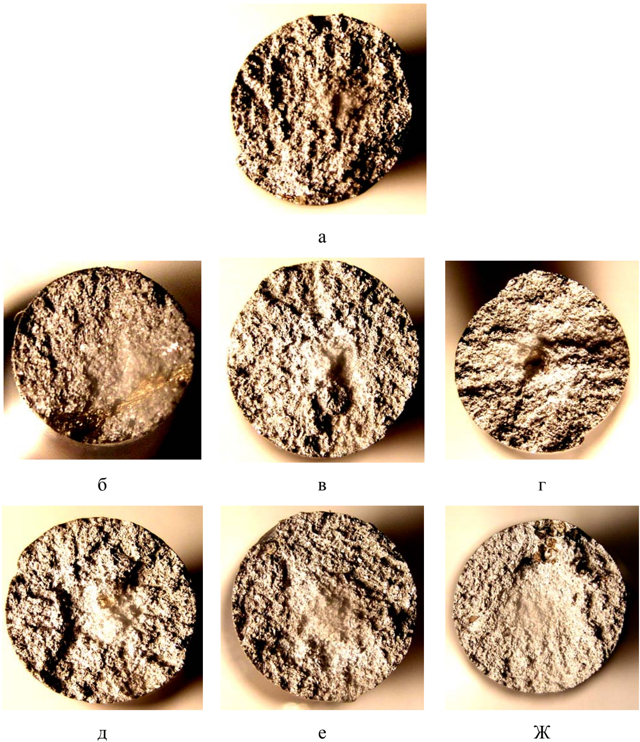
Рисунок 3.4 - Макрофрактограми зразків зі сплаву МЛ5 з різним вмістом вуглецю, \times 5 :
