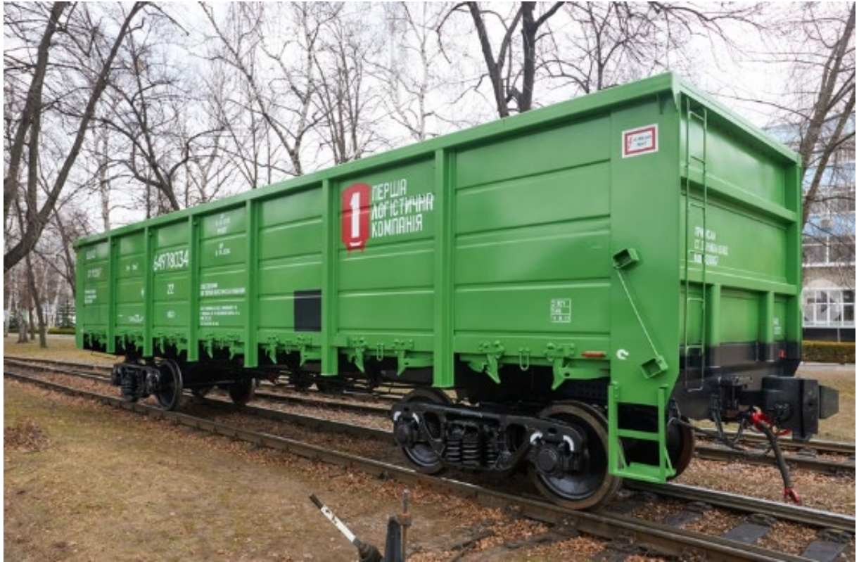
Рисунок 2.2 – Піввагон Крюківського вагонобудівного заводу моделі 12-783
