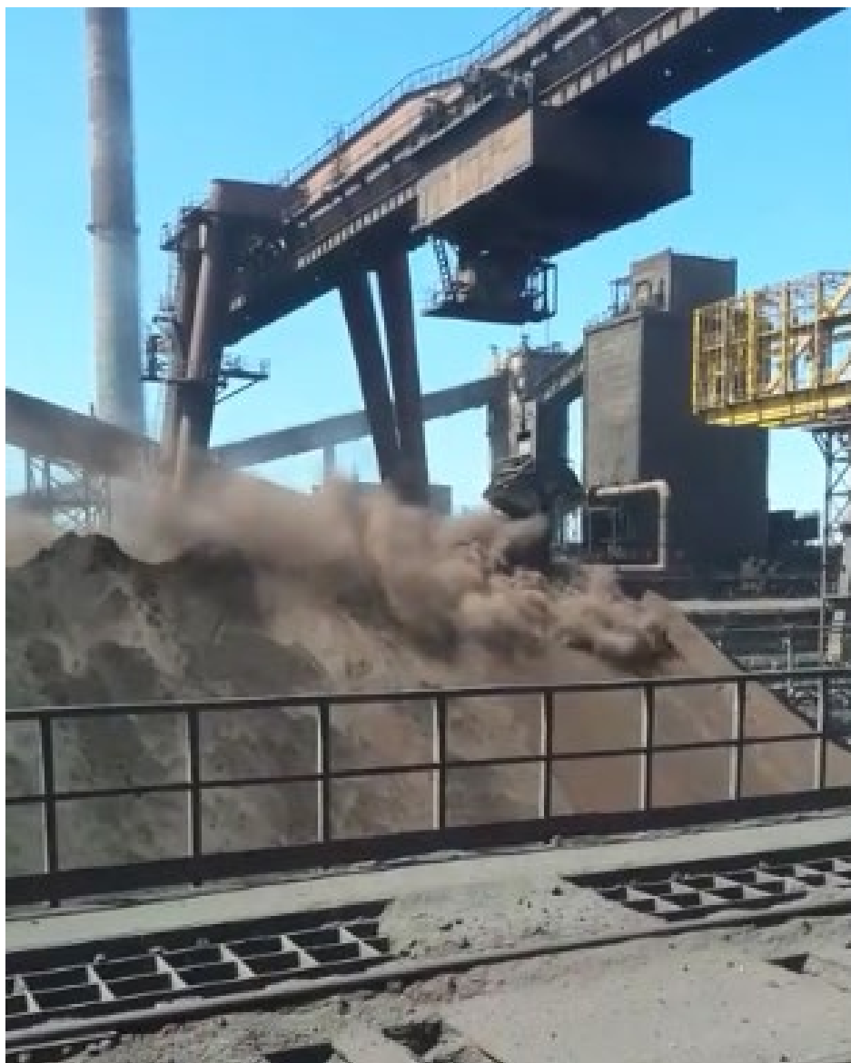
Рисунок 1.10 – Переміщення матеріалів у штабелі шихти рудно-грейферним перевантажувачем
