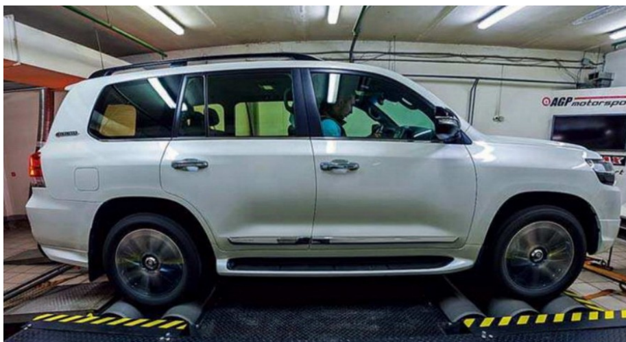
Рисунок 5.2 – Встановлення автомобіля на роликівий стенд
