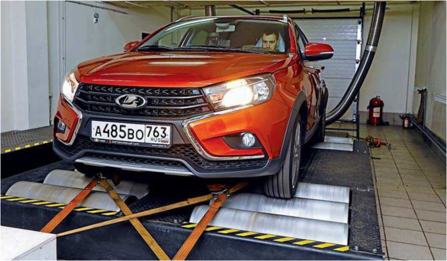
Рисунок 5.3 – Фіксація автомобіля на роликовому стелді розчалуванням
