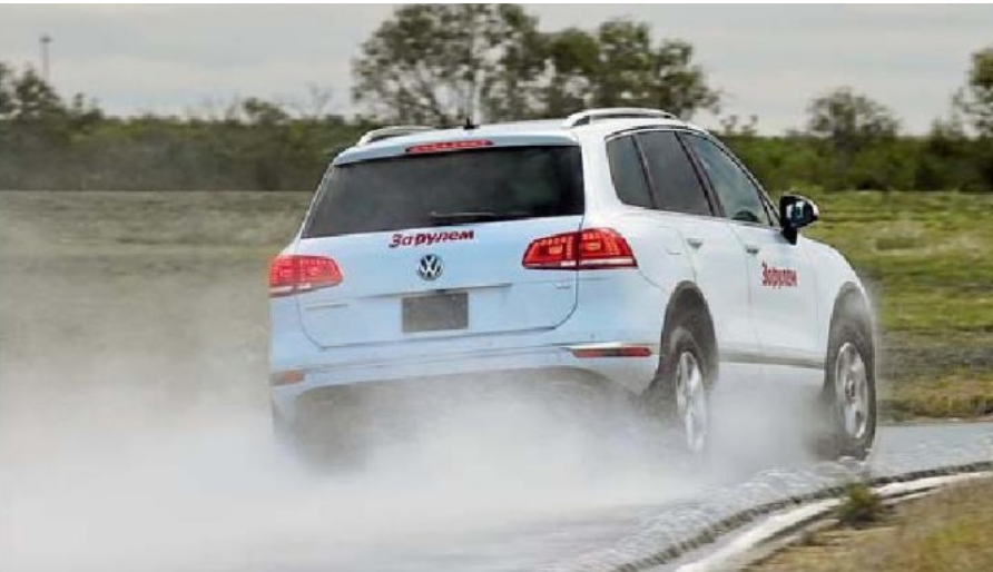
Рисунок 7.22 – Рух автомобіля по окружності на горизонтальній поверхні з малим коефіцієнтом зчеплення
