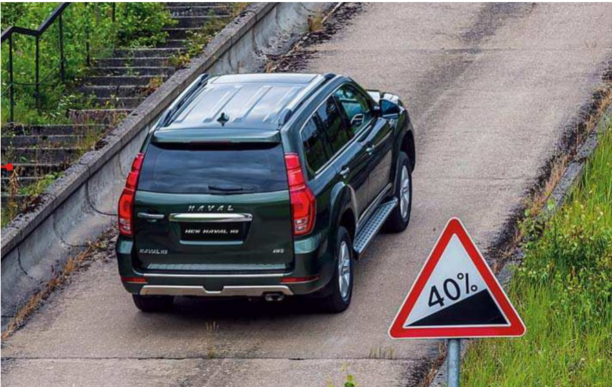
Рисунок 6.7 – Визначення кута підйому подоланого автомобілем
