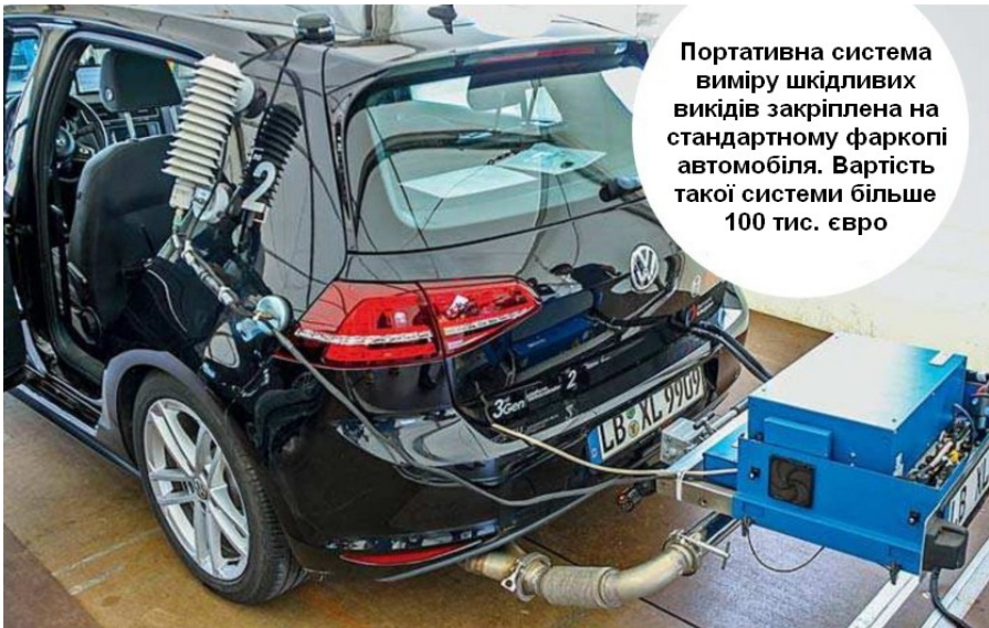
Рисунок 6.12 – Апаратура для виміру токсичності відпрацьованих газів під час дорожніх випробувань
