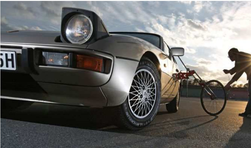
Рисунок 6.3 – Варіанти кріплення "п'ятого колеса" збоку автомобіля
