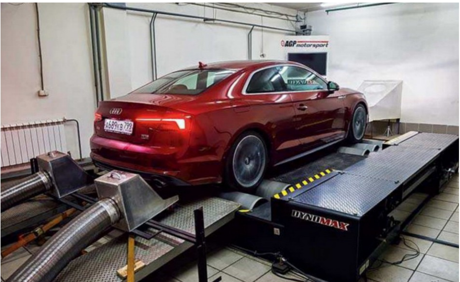
Рисунок 5.4 – Установлення системи відводу відпрацьованих газів
