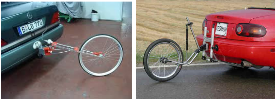
Рисунок 6.2 – Варіанти кріплення "п'ятого колеса" позаду автомобіля
