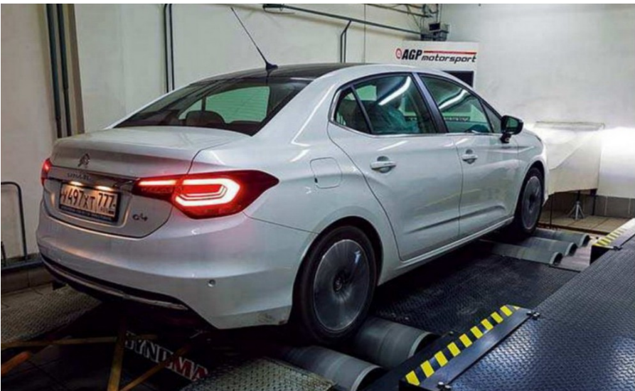
Рисунок 5.6 – Процес вимірювання тягово-швидкісних характеристик автомобіля на роликовому стенді
