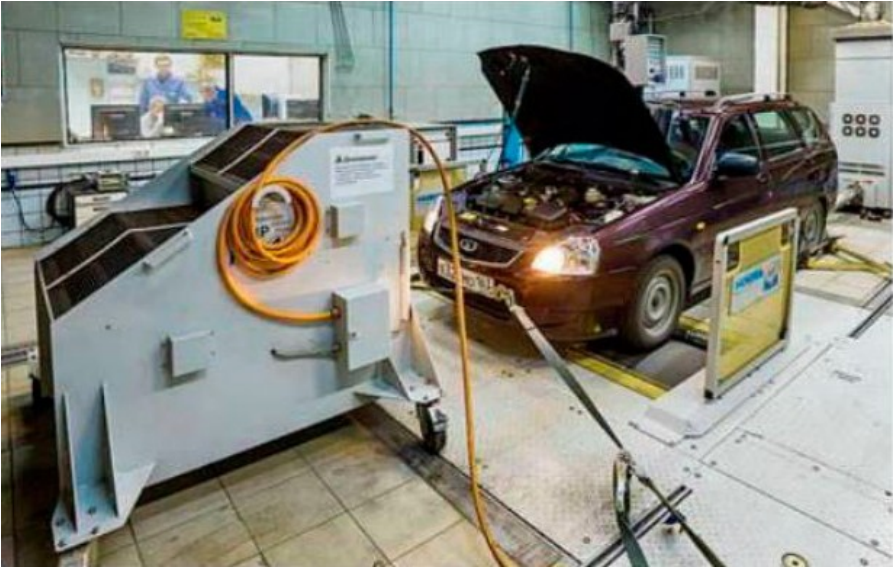
Рисунок 5.5 – Вентилятор встановлений для обдуву двигуна під час випробувань автомобіля на барабанному стенді
