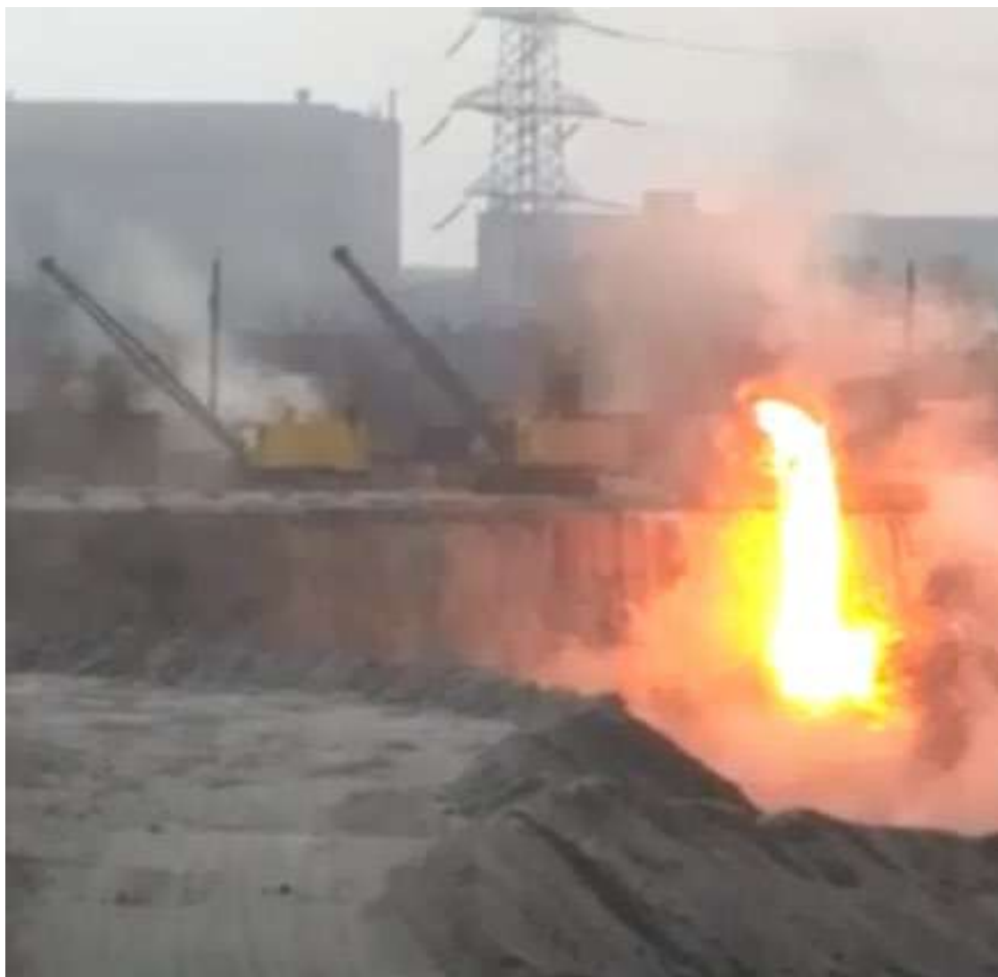
Рисунок 1.3 – Зливання шлаку у відвал
