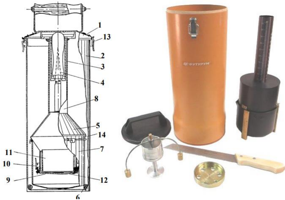
Рисунок 1.17 – Густиномір-вологомір Ковальова: 1 – кришка футляра; 2 – відро-футляр; 3 – сталева насадка; 4 – ніж; 5 – поплавок; 6 – гумове кільце; 7 – судина; 8 – трубка поплавка; 9 – кришка поплавка; 10 – замок поплавка; 11 – різальний циліндр; 12 – тарувальний вантаж; 13 – замок футляра; 14 – гачки
