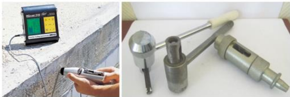
Рисунок 1.10 а – молоток Шмідта; б – молоток Кашкарова; с – Ультразвуковий прилад для обстеження конструкцій
