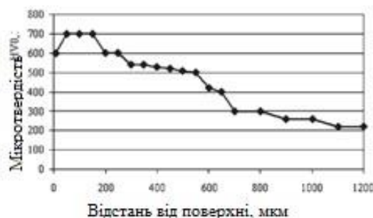
Рисунок 3.4 – Розподіл мікротвердості за товщиною дифузійного шару після цементації
