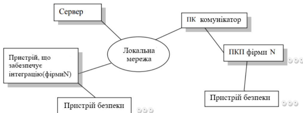
Рисунок 1.5 - Узагальнена схема інтегрованої системи безпеки з апаратною інтеграцією компонентів
