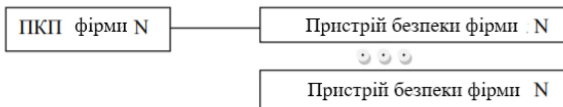
Рисунок 1.3 - Узагальнена схема автономної системи безпеки
