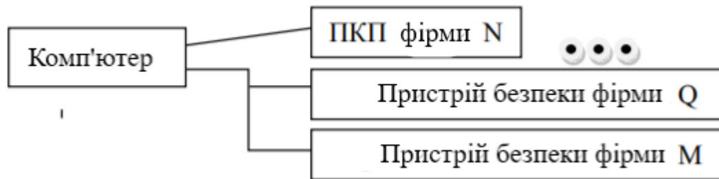
Рисунок 1.4 - Узагальнена схема обособленої системи безпеки
