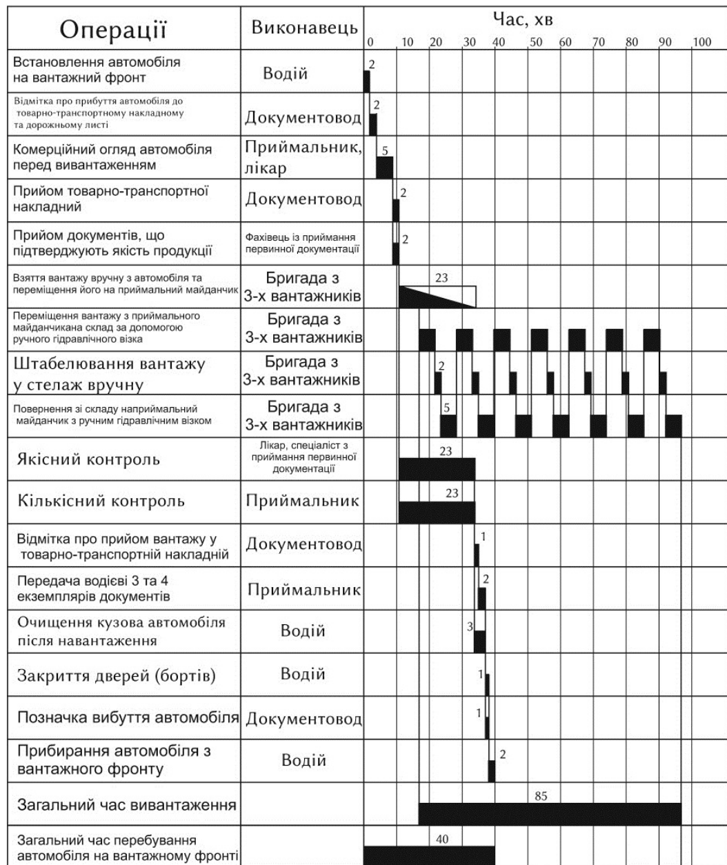
Рисунок 2.2 – Технологічний графік вивантаження транспортного засобу по базовому варіанту
