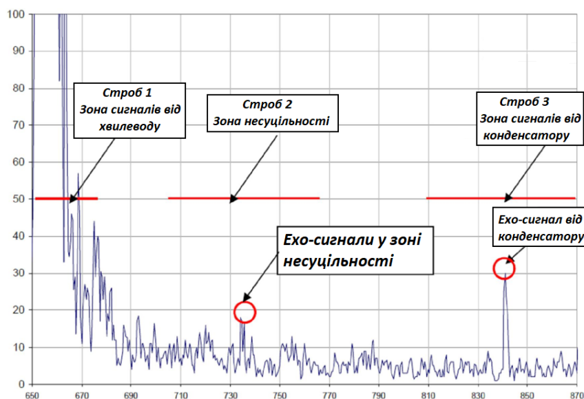
Рисунок 3.8 - Еталонний А-скан перед початком УЗ моніторингу
