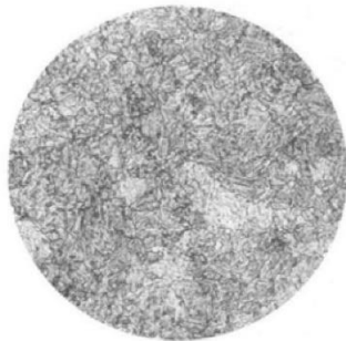
Мікроструктура основного металу після 100 \times 10^3 год експлуатації, \times 500
