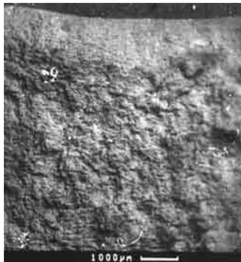
Рисунок 4.5 - Фрактограма поверхні руйнування після випробування на ударну в'язкість зразка зі сталі 12Х1МФ, вирізаного із труби після тривалої експлуатації ( \times 12 )
