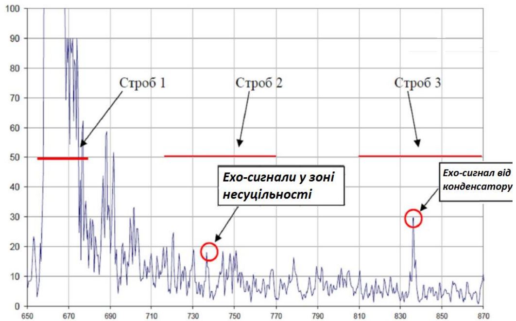
Рисунок 3.9 - А-скан при розігріві РУ
