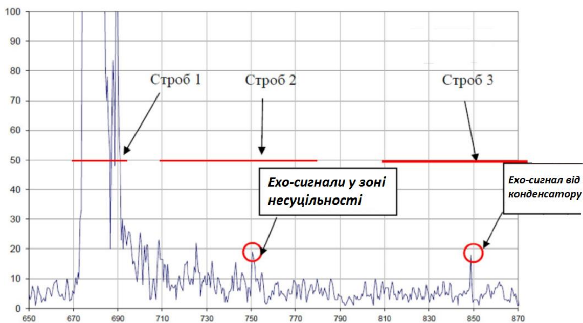
Рисунок 3.11 - А-скан при зупинці (розхолоджуванні) РУ
