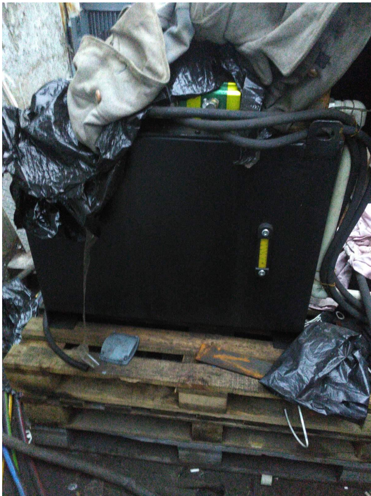
Рисунок 1.5 – Розширювальний бак ЦСЗ цільового кульового млина
