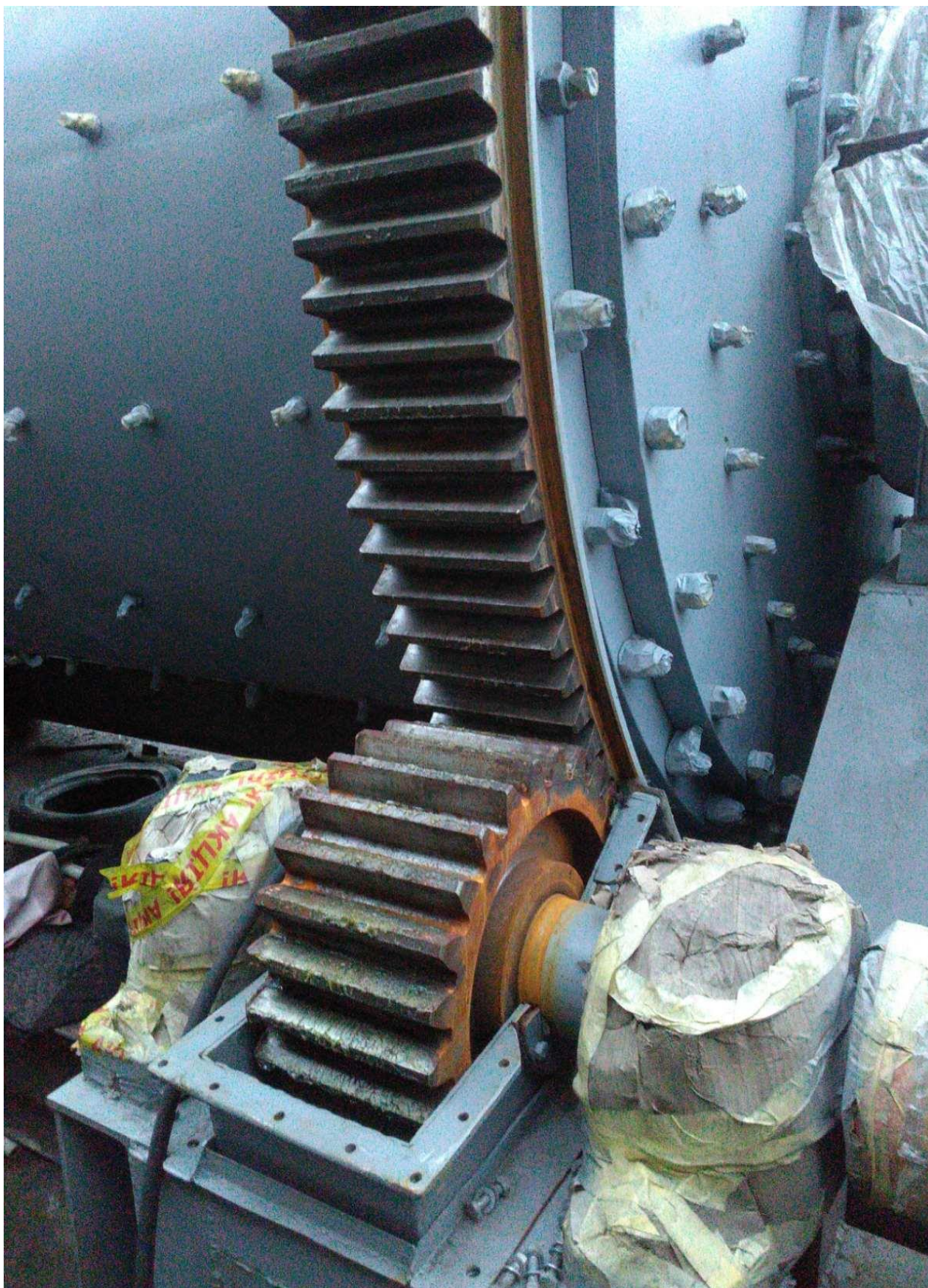
Рисунок 1.4 – Зубчасте з'єднання шестерні основного редуктора та зубчастого вінця барабану млина
