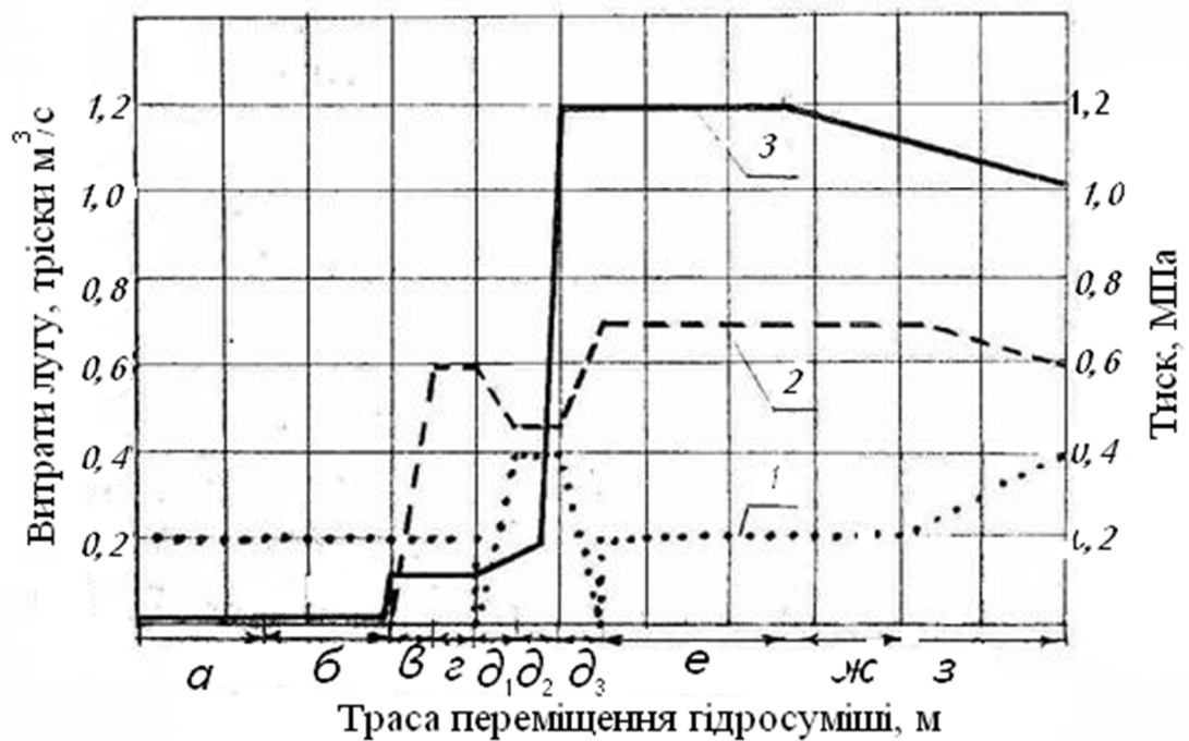
Рисунок 2.2 Розподіл витрати тріски, лугу і тиску гідросуміші по складній трасі лінії завантаження установки Камюр : 1. Витрата тріски; 2. Витрата гідросуміші; 3. Тиск гідросуміші, м³/с.
