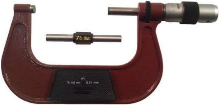
Рисунок 2.2 – Інструмент з еталонним вкладишем
