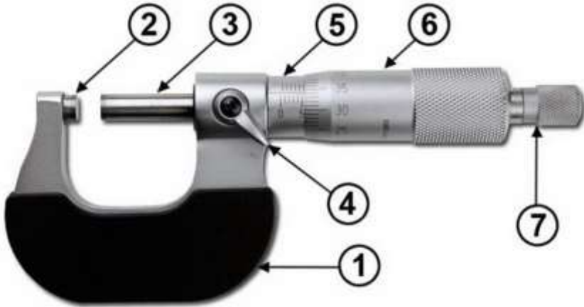
Рисунок 2.1 – Конструкція гладкого мікрометра
