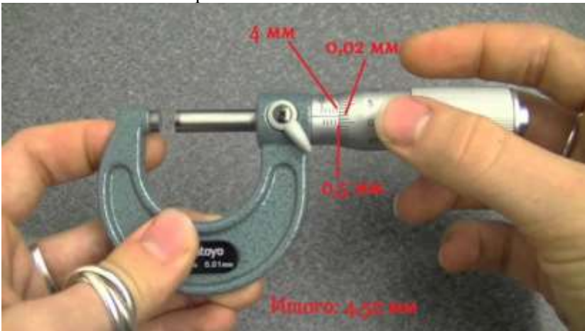
Рисунок 2.3 – Приклад обчислення показань мікрометра
