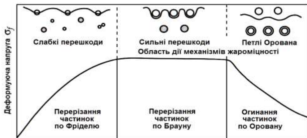
Рисунок 1.6 - Механізм зміцнення ливарних ЖНС частинками \gamma' - фази (об'ємна кількість частинок постійна) [1-3, 117, 118, 187-191, 196]
