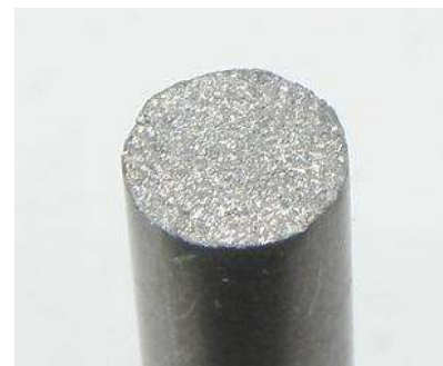
Рисунок 4.13 - Типовий злам зразків сплаву ЗМІ-3У-М1 після механічних випробувань на короточасну міцність при 20 0 С без формування шийки: ×5
