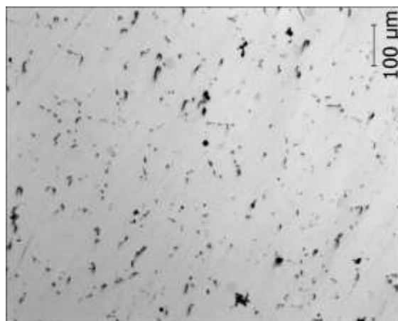
Рисунок 5.2 - Мікроструктура зразків рівновісгової кристалізації сплаву ЖСЗЛС-М в литому стані (без травлення): \times 200
