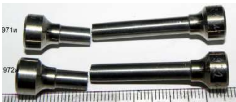
Рисунок 4.13 - Типовий злам зразків сплаву ЗМІ-3У-М1 після механічних випробувань на короточасну міцність при 20 0 С без формування шийки: ×5
