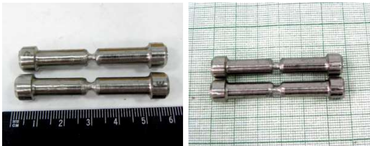
Рисунок. 2.5 – Циліндричні зразки типу РК-3 с кільцевим надрізом під зварювання
