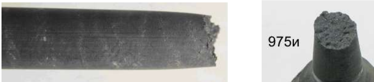
Рисунок 4.15 - Характерний дендритно-ямковий злам у зразків сплаву ЗМІ-3У-М1 після випробувань на тривалу міцність при t = 975^{\circ}\text{C} і напрузі \sigma = 260 \text{ МПа} . з утворенням шийки: \times 5
