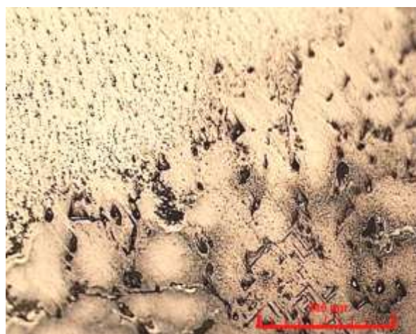
Рисунок 5.19 - Мікроструктура зразка-темплета сплаву ВЖЛ12Е в зоні зварювання, що сформована серійної присадкою ЕП367
