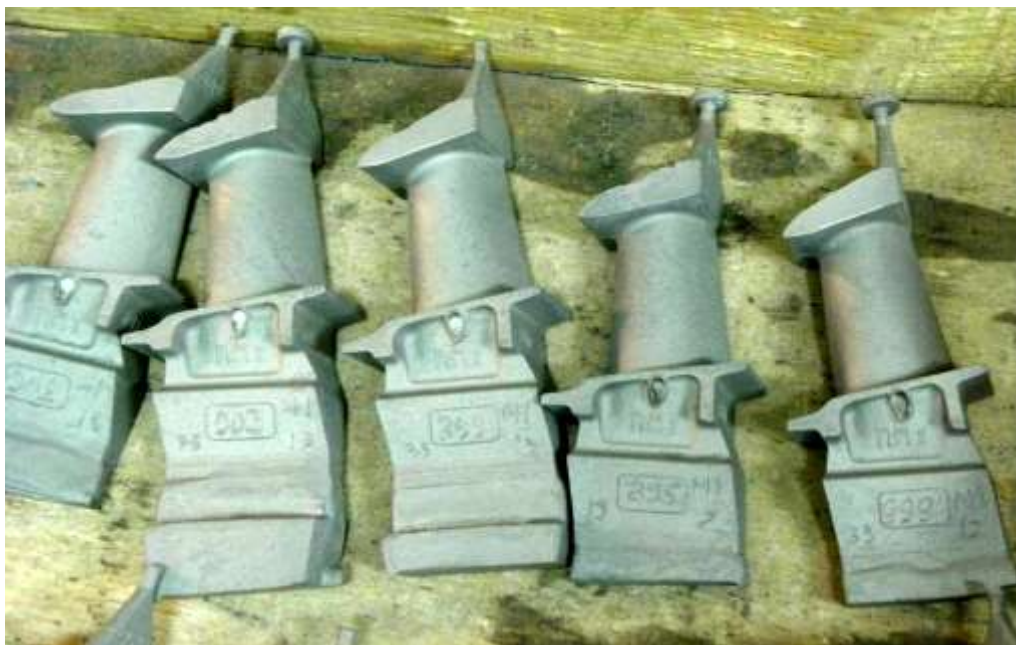
Рисунок - 4.20 - Литі робочі лопатки першого ступеня, виготовлені методом спрямованої (моно) кристалізації з розробленого сплаву ЗМІ-3У-М1
