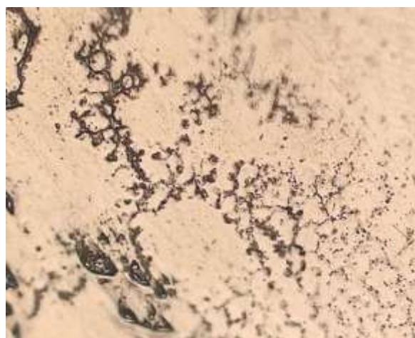
Рисунок 5.19 - Мікроструктура зразка-темплета сплаву ВЖЛ12Е в зоні зварювання, що сформована серійної присадкою ЕП367
