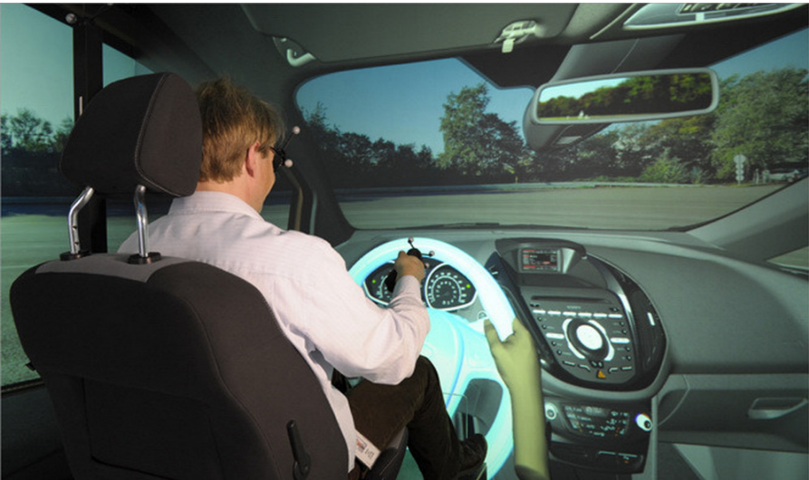
Рисунок 2.12 - "Віртуальна перевірка" зовнішньої оглядовості з місця водія
