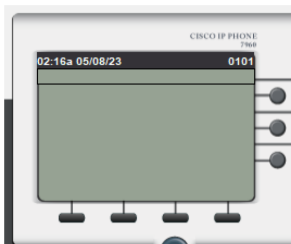
Рисунок 3.13 — Результат роботи сервера часу на ір-телефоні
