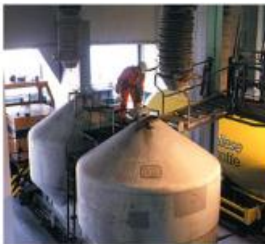
Рисунок 1.5 – Система для завантаження сухої золи у вагони
