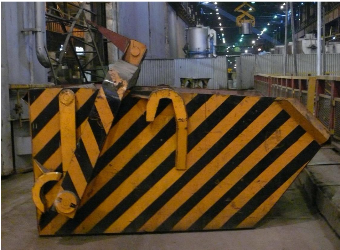
Рисунок 1.5 – Саморозвантажувальний короб та схема його переміщення вантажопідйомним краном
