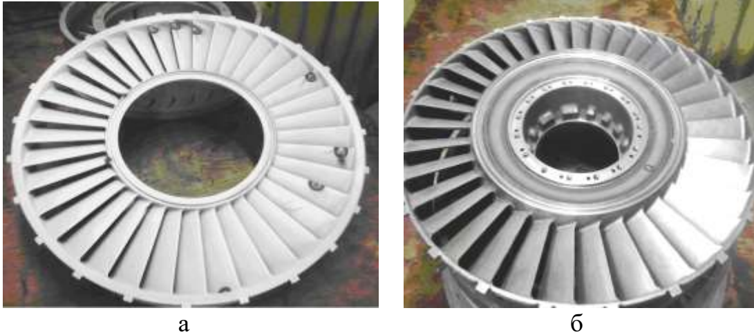
а – усунення ливарних дефектів методом АДЗ; б – придатний СА після механічної обробки.
