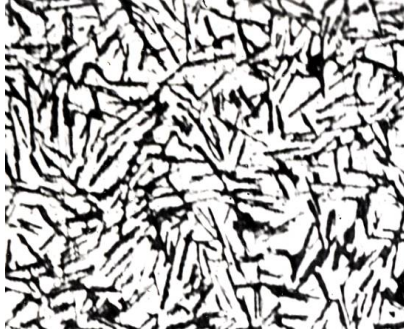
Рисунок 2.3 – Мікроструктура окисленої зони нетравленого цементованого шару
