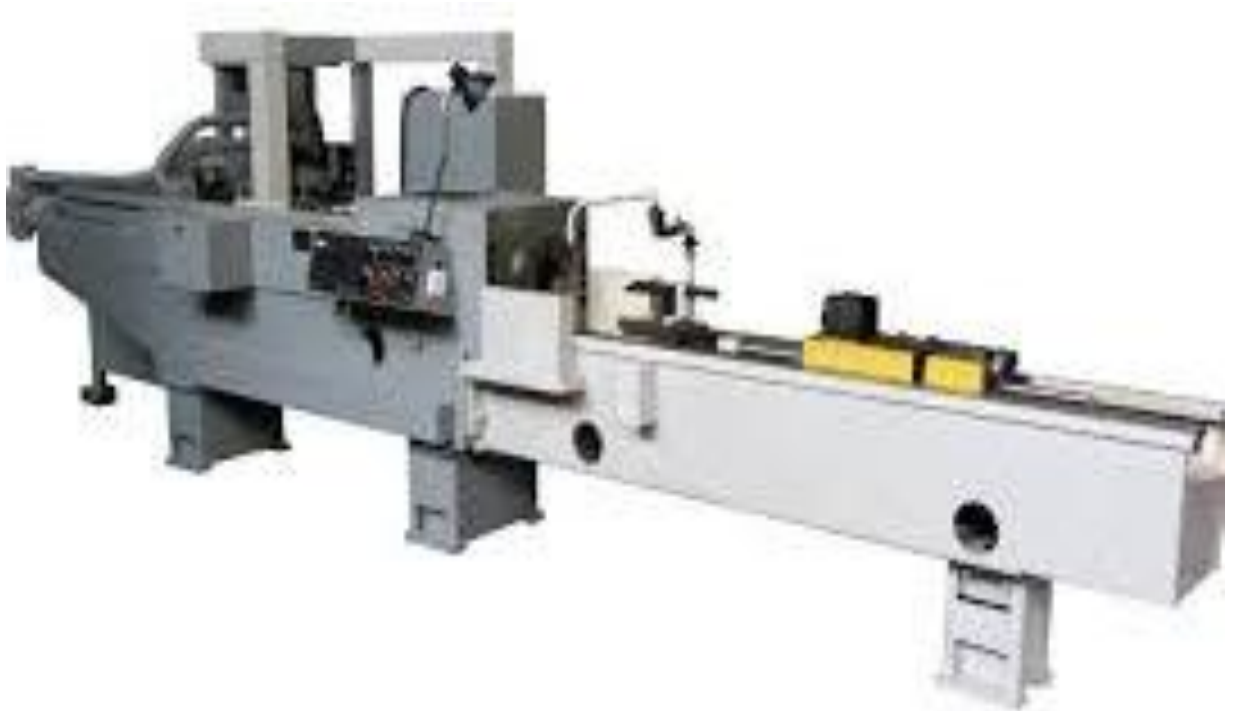
Рисунок 2.28 – Горизонтально-протяжний станок 7A520
