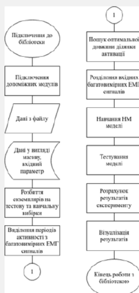
Рисунок Б.9 – Схема функціонування програмної бібліотеки
