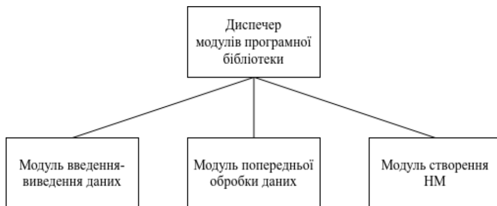
Рисунок 3.1 – Структурна схема програмної бібліотеки
