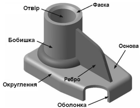
Рисунок 3.4 - Основні елементи 3D-моделі деталі
