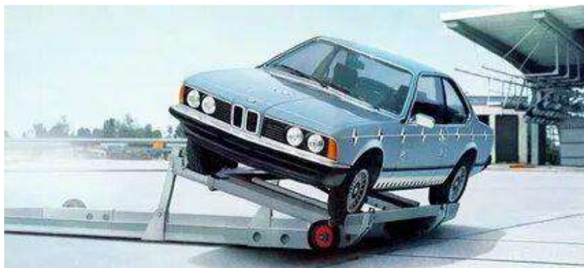
Рисунок 11.2 – Експериментальне перекидання автомобіля BMW. Під час якого середній відсік піддається зім'яттю
