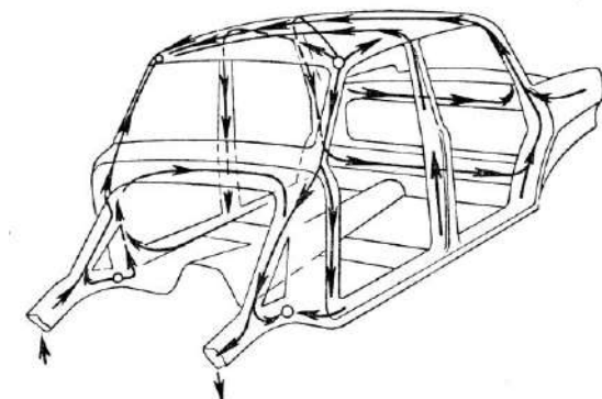
Рисунок 6.2 – Напрямок «потoku» зусиль у корпусі кузова при підйомі правого переднього колеса
