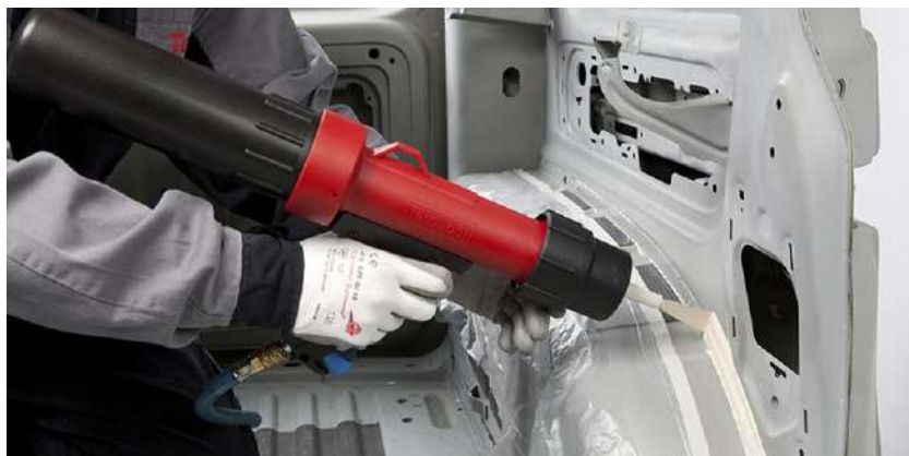
Рисунок 5.4 – Процес нанесення герметика у місці з'єднання деталей кузова автомобіля
