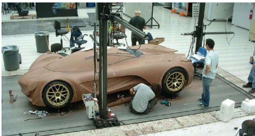
Рисунок 13.11 – Обмір пластилінового макета кузова координатно-вимірювальною машиною
