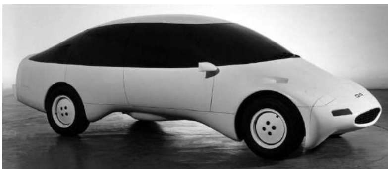
Рисунок 10.10 – Кузов автомобіля з мінімальним аеродинамічним опором Pininfarina CNR-PF
