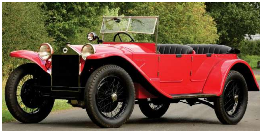
Рисунок 1.8 – Автомобіль «Lambda» фірми Lancia (1922 р.). Заміна рами шасі конструкцією кузова
