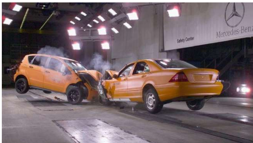
Рисунок 11.1 – Експериментальне лобове зіткнення двох автомобілів Mercedes-Benz
