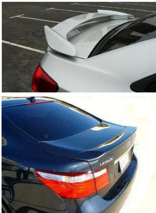
Рисунок 10.9 – Кузова із задніми спойлерами
