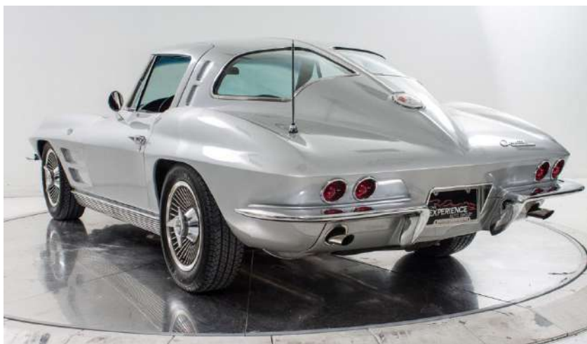
Рисунок 5.1 – Пластмасовий кузов автомобіля Chevrolet-Corvette – Stingray
