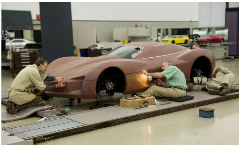
Рисунок 13.10 – Процес виготовлення макета кузова майбутнього автомобіля вручну
