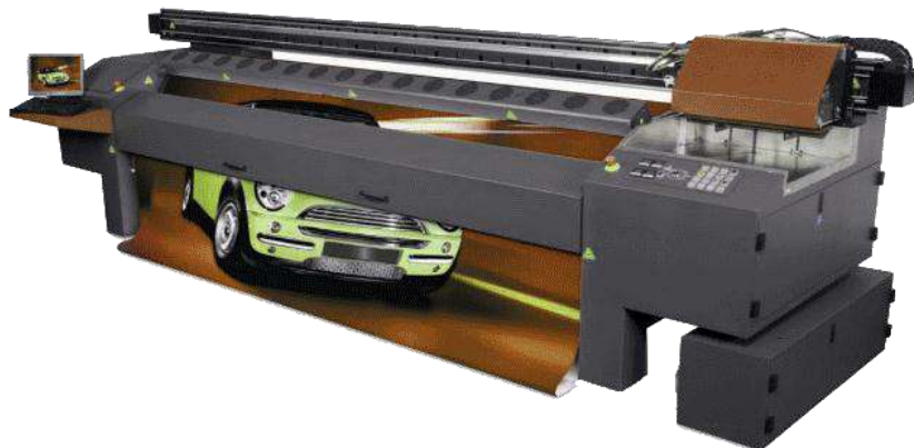
Рисунок 13.12 – Виконання плоского креслення плотером, керованим комп'ютером
