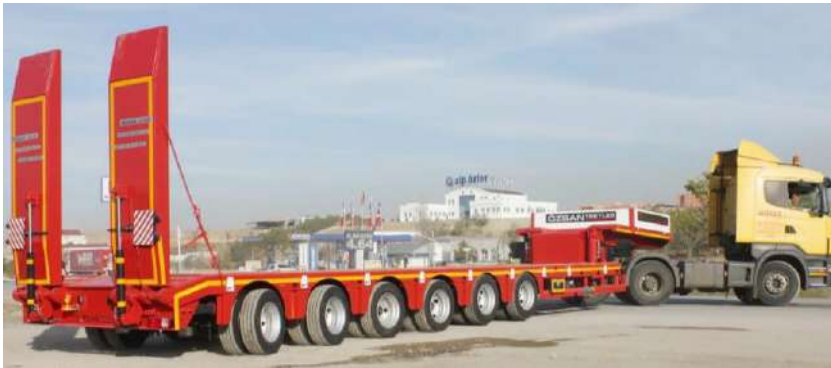
Рисунок 4.13 – Напівпричеп вантажопідйомністю 75 тон
