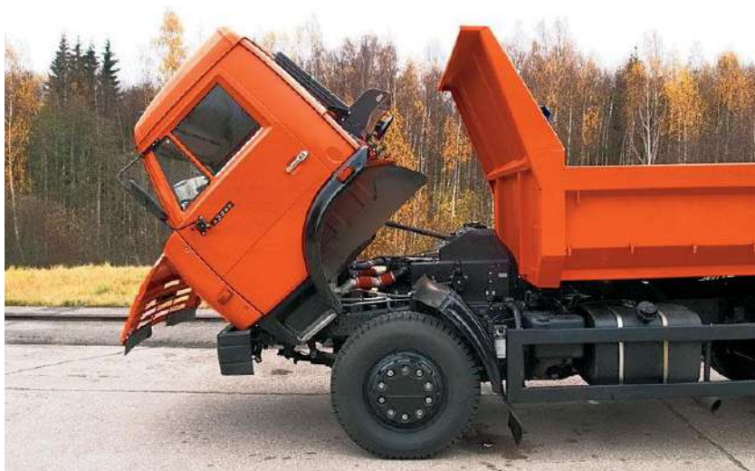
Рисунок 6.10 – Автомобілі сімейства КамАЗ є прикладом виконання відкидної кабіни
