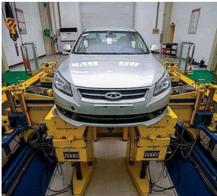
Рисунок 11.3 – Загальне випробування кузова автомобіля на міцність
