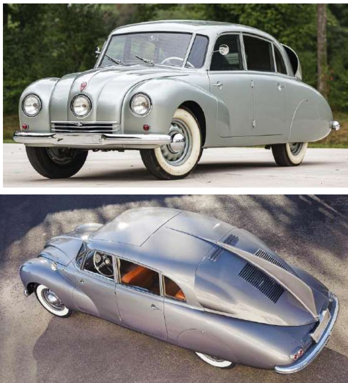
Рисунок 10.8 – Аеродинамічний кузов автомобіля «Татра – 87»
