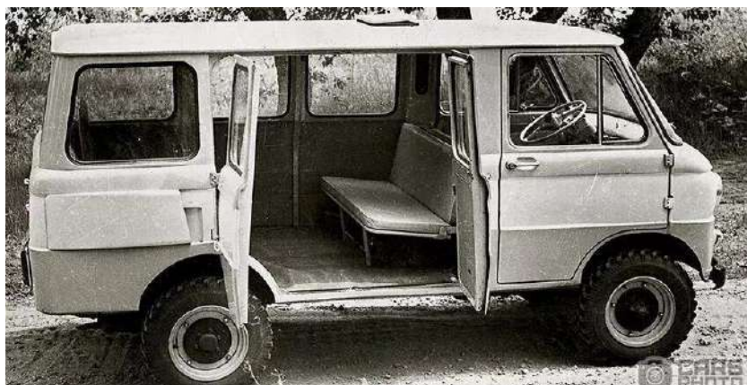
Рисунок 4.3 – Приклад кузова вагонної компоновки: експериментальна версія «мінівена ЗАЗ» створена на основі серійного ЗАЗ-965 (1960-ті роки)
