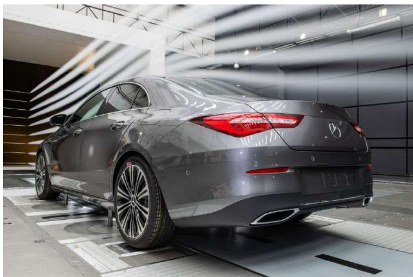
Рисунок 10.20 – Визначення в аеродинамічній камері напрямків повітряних потоків, що обтікають поверхню автомобіля Mercedes-Benz CLA купе 2019
