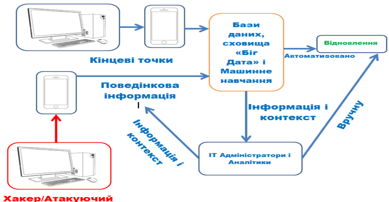
Рисунок 1.4 – Принцип роботи архітектури EDR
