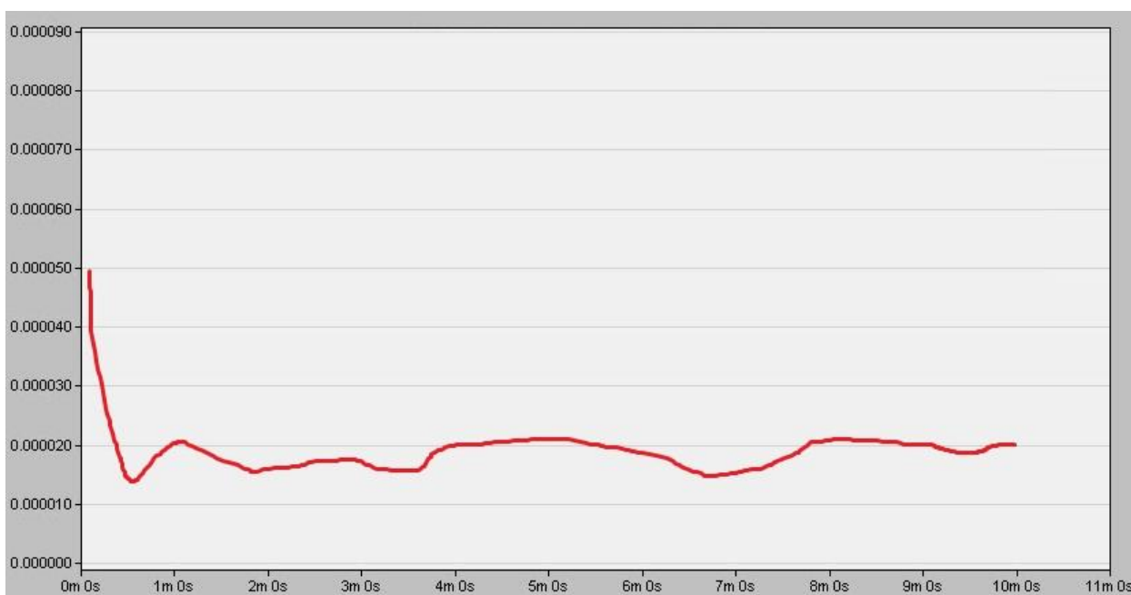
Рисунок 3.14 – Характеристика задержки передачи кадров end to end при увеличенном количестве 3G камер
