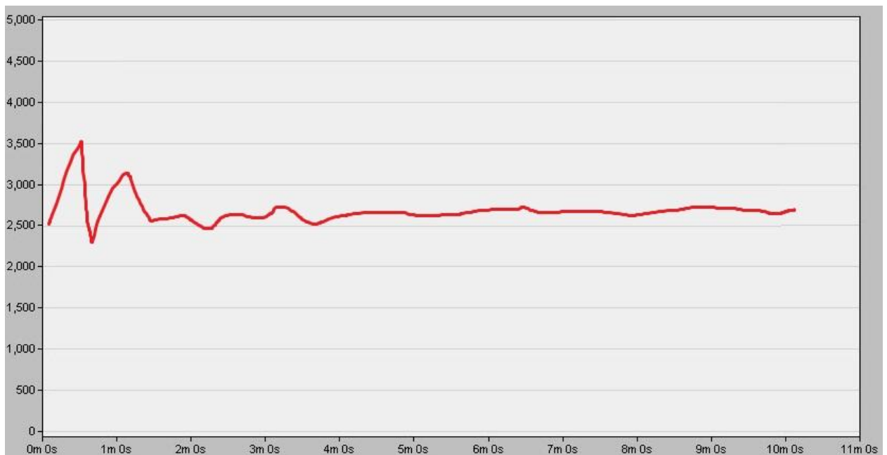
Рисунок 3.18 – График предположительной нагрузки, которую должна обслуживать сеть, при увеличенном количестве 3G-камер и при увеличенном расстоянии до БС
