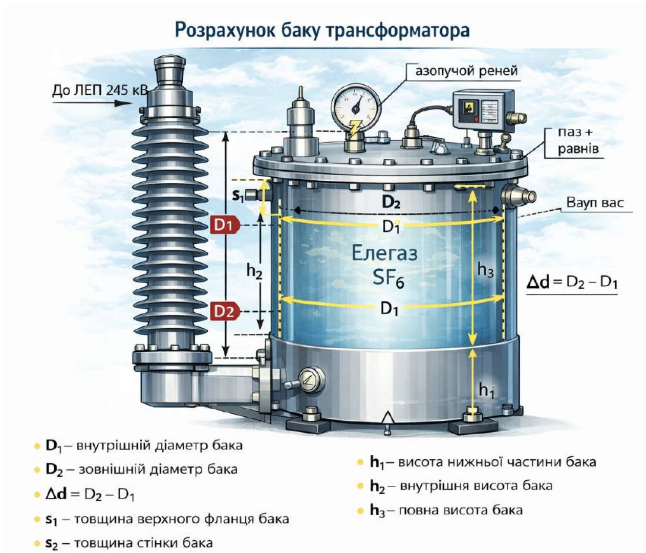
Рисунок 5.4 – Бак трансформатора струму ТОГ-245
