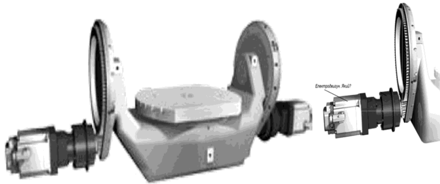
Рисунок 1.1 – Двохосьовий поворотний стіл HERMLE з зубчастим приводом
