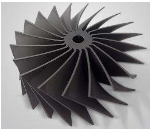
Рисунок 5.6 – Отримана складна поверхня (робоче колесо), непрофільним електрод-інструментом (дротом)
