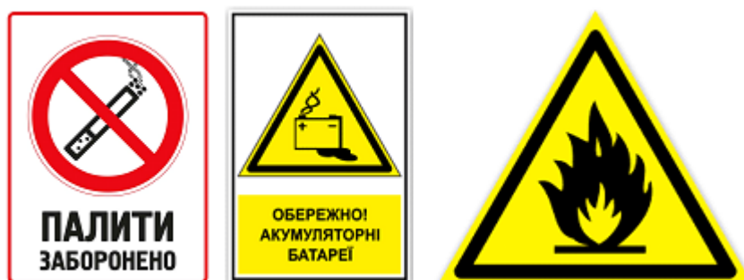
Рисунок 4.4 – Попереджувальні знаки на приміщенні зарядної станції для акумуляторних батарей навантажувачів
