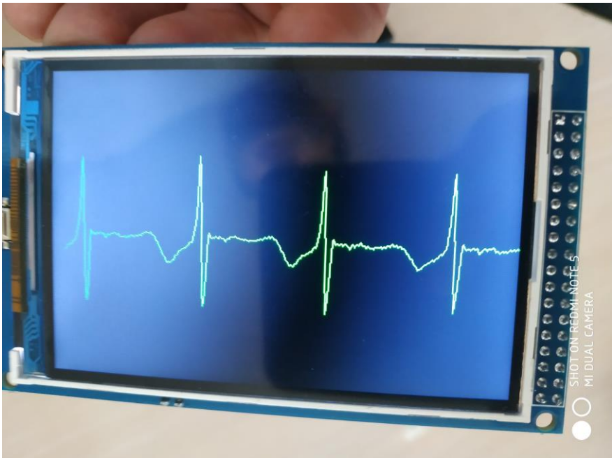
Рисунок 1.12 - Приклад роботи виводу ЕКГ на TFT дисплей
