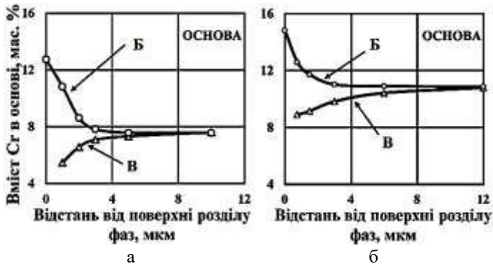
Рисунок 7 – Зміни вмісту Cr в основі чавунів із 11,9 % Cr (а) та 19,7 % Cr (б) від поверхні розділу фаз основа – пора: напрямок Б та карбід – основа: напрямок В
