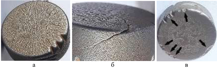
а – жолобки; б – тріщини; в – відокремлення фрагментів
