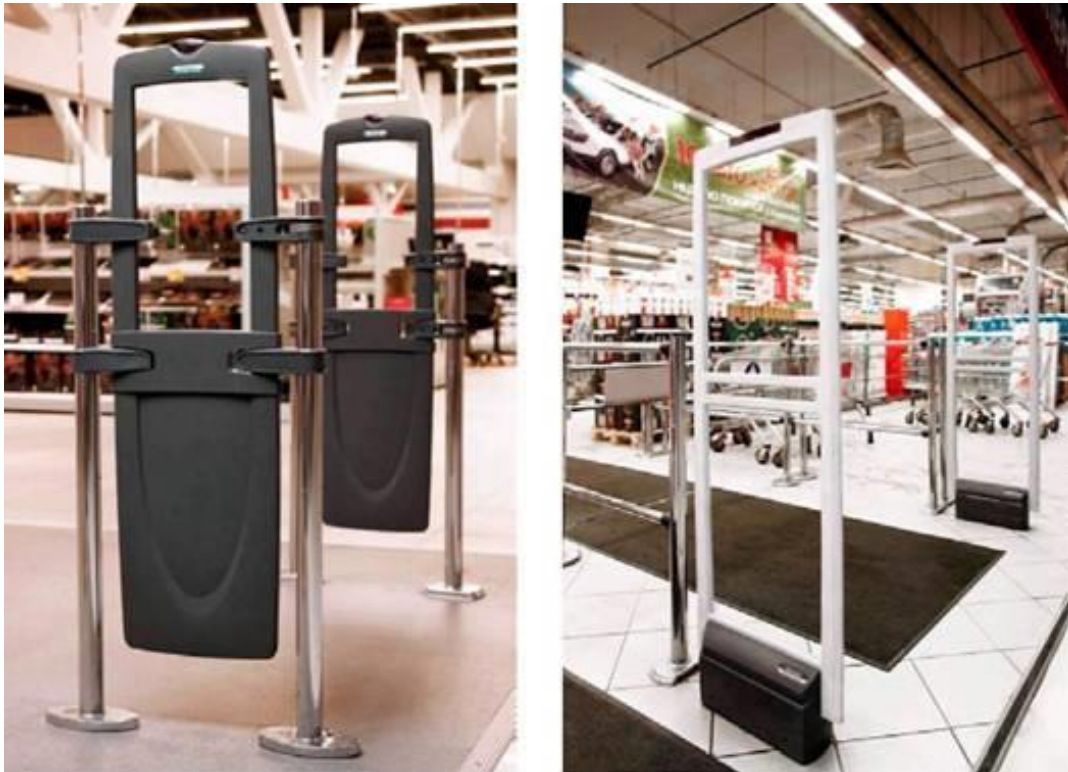
Рисунок 2.5 – Фіксований RFID зчитувач [14]
