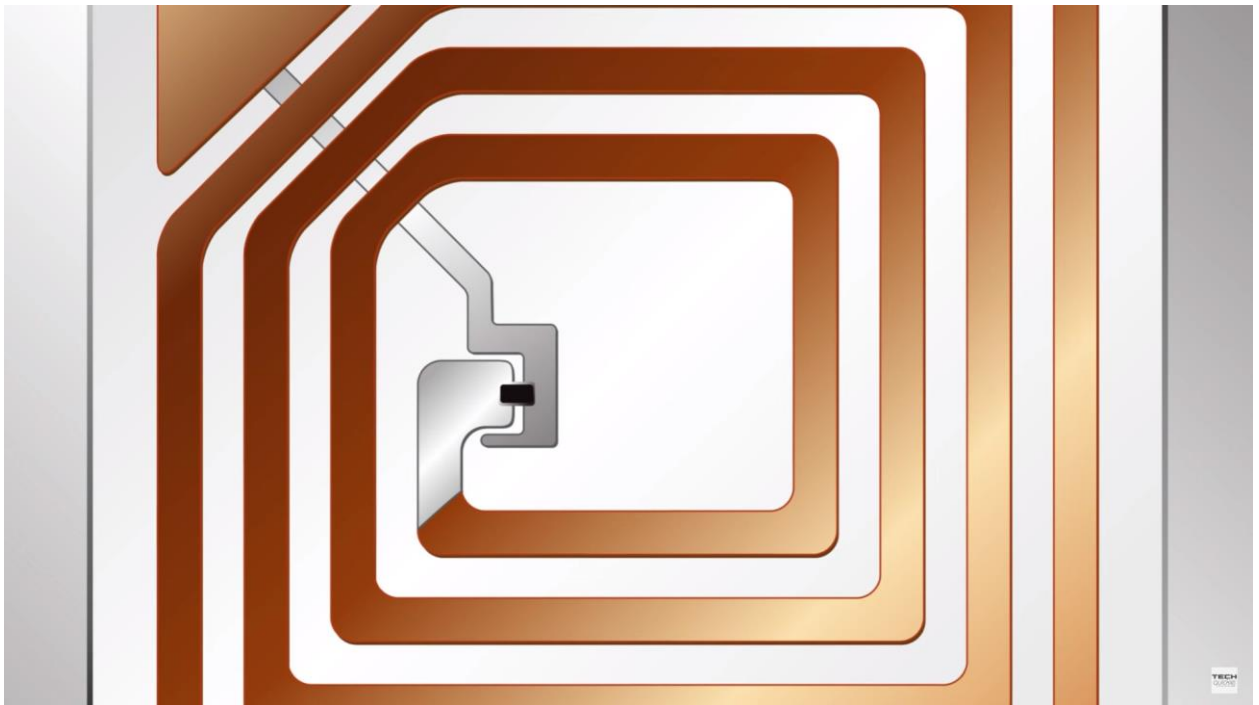
Рисунок 2.4 – Радіочастотний RFID тег [13]
