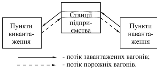
Рисунок 1.4 – Структура внутрішніх вагонопотоків металургійного підприємства
