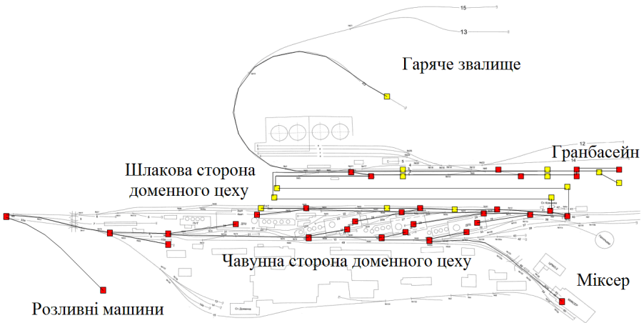
Рисунок 7.7 – Топологія транспортної мережі моделі МЛС перевезень рідкого доменного шлаку
