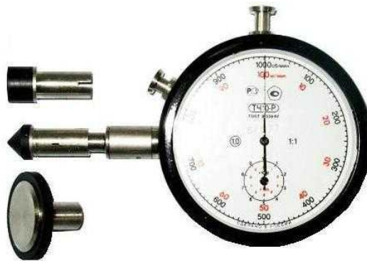
Рисунок 2.1 - Тахометр годинного типу ТЧ-10Р
